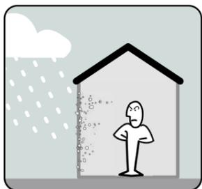
**Desgaste da superfície das paredes exteriores**, por causa da chuva e do vento, o que leva a que os grãos mais finos da taipa sejam lavados, ficando à vista o osso.
