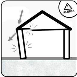
**Fissuras em várias direções ou deformações da parede** podem ser consequência de forças aplicadas numa pequena área da parede, devido por exemplo ao mau estado de outras partes do edifício, alterações, acrescentos, vigas podres, etc.
