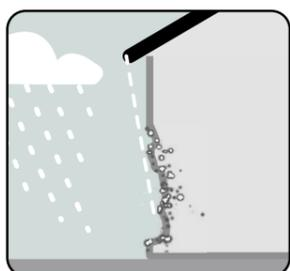
**Desgaste acelerado em determinados pontos da parede** pode acontecer por várias razões, por exemplo caleiras pouco capazes, pingadeiras mal feitas ou não pensadas, mau capeamento dos muros e peitoris ou até mesmo o efeito da chuva a salpicar no chão para a base da parede.
